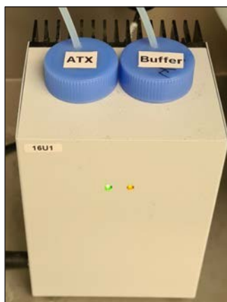
Positie van de bufferbuis in het koelblok
