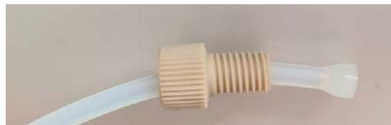
Huls correct bevestigd
