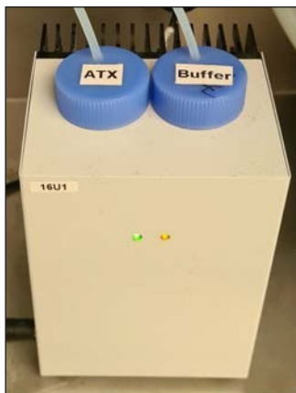
Positie van ATX-buis in het koelblok
