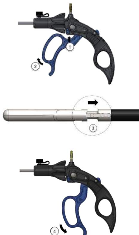
1. Com a pega na posição de pistola, pressione o botão de liberação do componente de encaixe (G) e move o gatilho (F) totalmente para a frente, para a posição de ejeção.
