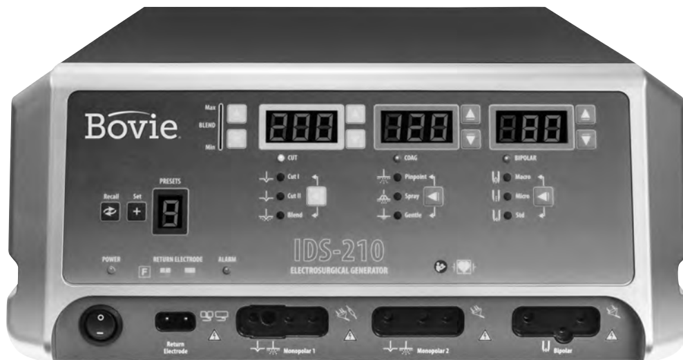
Figura 2 – 1 Schema situații butoanelor de control, indicatorilor și conectoarele de ieșire pe panelul frontal
