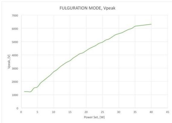
Figura 6 Configuração de potência em comparação à tensão (pico de tensão) Bipolar
