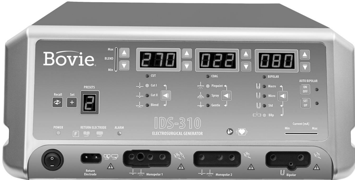
Figura 2 – 1 Disposizione dei tasti di comando, indicatori e prese sul pannello anteriore
