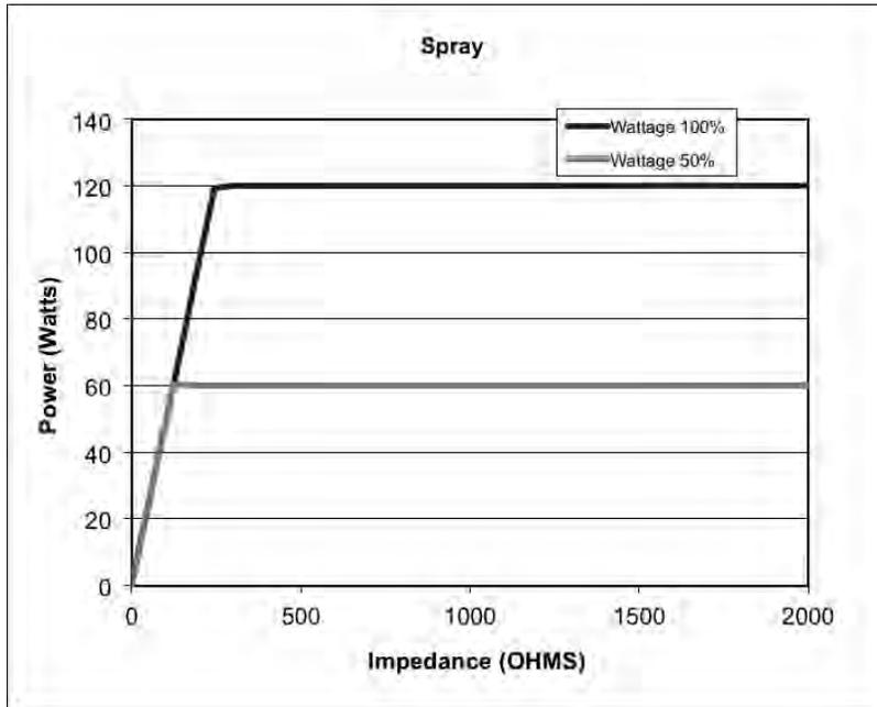
Figura A- 6 Nivel de potencia de salida frente la impedancia en modo GENTLE COAGULATION
