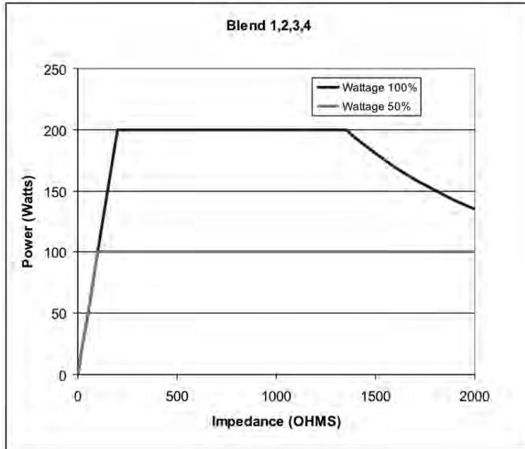
Figura A – 4 Nivel de potencia de salida frente la impedancia en modo PINPOINT COAGULATION
