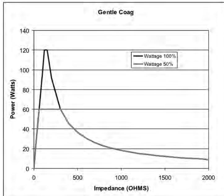
Figura A- 7 Potencia de salida frente la impedancia en modo MACRO BIPOLAR
