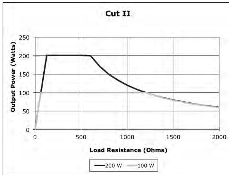
Figura A – 3 Nivel de potencia de salida frente la impedancia en modo BLEND (1, 2, 3, 4)
