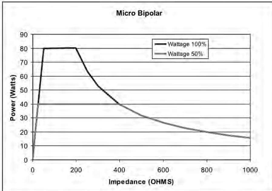
Figura A-9 Potencia de salida frente la impedancia en modo STANDART BIPOLAR
