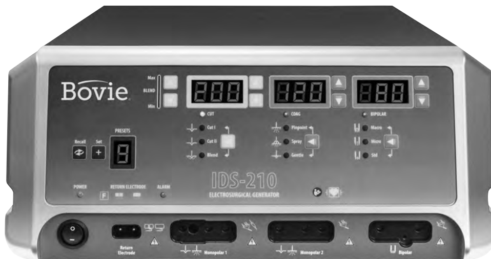
Фигура 2 – 1 Изглед на разположението на бутоните за управление, индикаторите и изходните букси на предния панел
