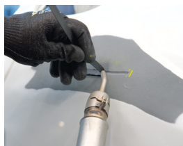
Pęknięcia i rozdzielania zderzaków
