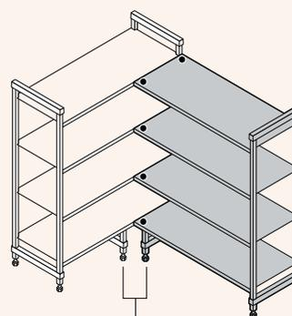
在每个基础架和扩展架下方使用一个垫货支架。
