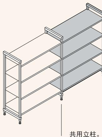
**拐角货架：基础架 + 扩展架（带有拐角接插件）**
