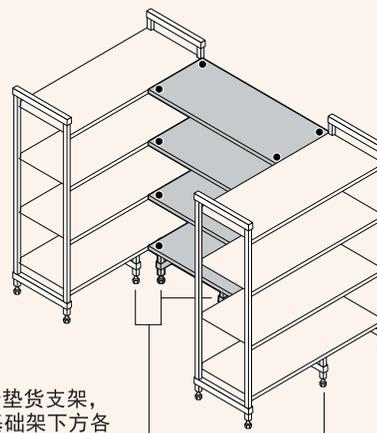
使用 4 个垫货支架，在每个基础架下方各用 1 个，在中间底架下方使用 2 个。
