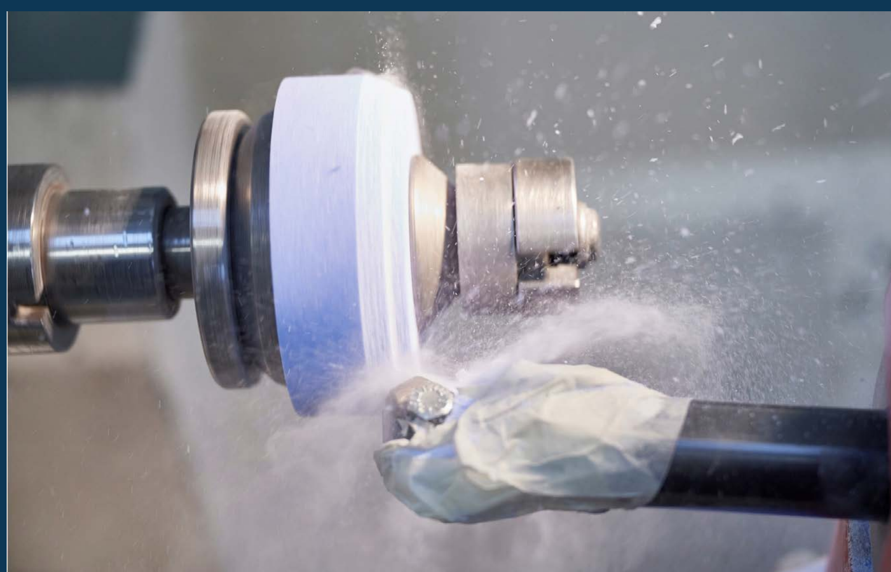
Abb. 1: Bearbeitung eines Schleifkörpers mit Staubentwicklung (Quelle: Mirka Abrasives Germany GmbH)
