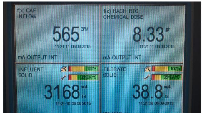
Figura 2: El control en tiempo real equilibra automáticamente los requisitos de TSS con los umbrales de pH, lo que evita tener que realizar mediciones y dosificaciones manuales.
