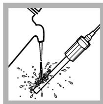
3. Lavare la sonda con acqua deionizzata. Asciugare la sonda con un panno privo di lanugine.
