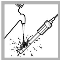
1. Lavare la sonda con acqua deionizzata. Asciugare la sonda con un panno privo di lanugine.
