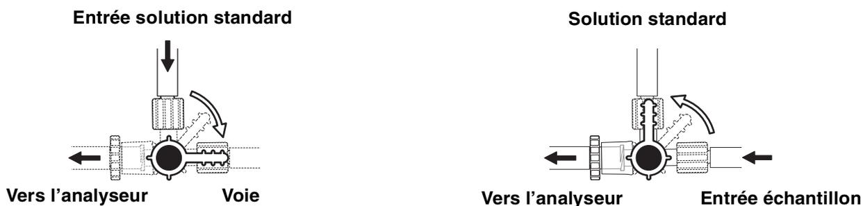
**A.** Dans cette position, l'échantillon ne s'écoule pas.
