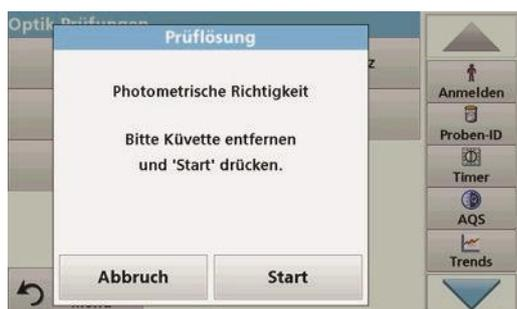
6. Entfernen Sie alle Küvetten aus dem Küvettschacht und tippen Sie auf **Start**.
