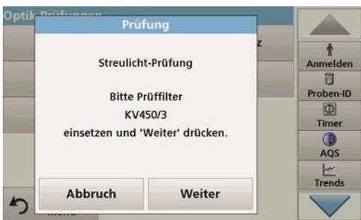
10. Folgen Sie den Anweisungen im Display und setzen Sie die unterschiedlichen Filter in der angezeigten Reihenfolge nacheinander ein.
