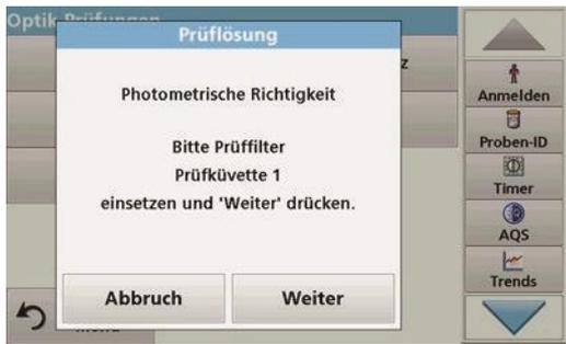
7. Setzen Sie Prüfküvette 1 (Abbildung 3, Seite 19) in Küvettschaft (1) ein und tippen Sie auf **Weiter**.
