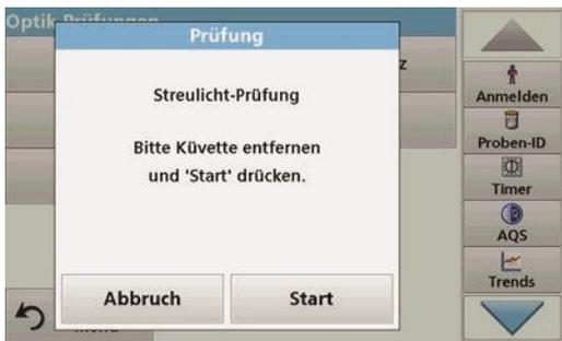
7. Entfernen Sie eventuell vorhandene Küvetten aus dem Küvetten schacht.
