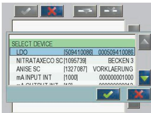
Figura 44 Menú de configuración del Profibus/Modbus —Seleccione dispositivo
