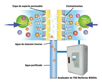
Para las aplicaciones de tratamiento de aguas en las que se emplea un sistema de ósmosis inversa, el analizador de TOC BioTector B3500c de Hach monitoriza el carbono orgánico total en la corriente de agua purificada a fin de garantizar que el sistema de ósmosis inversa funciona con el máximo nivel de eficiencia.
