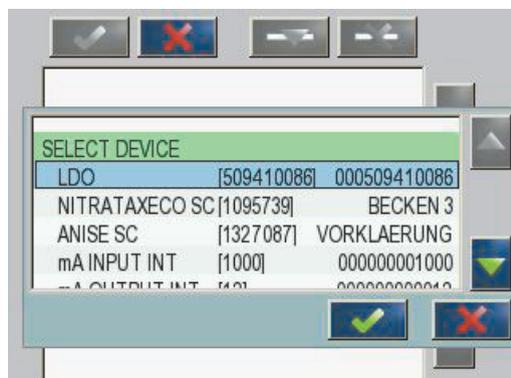
Figura 44 Menu di configurazione Profibus/Modbus:selezione di unità
