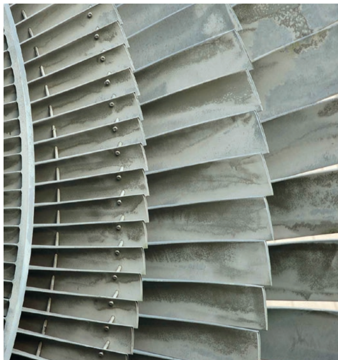
Le dépôt de silice sur les aubes des turbines est un problème critique
