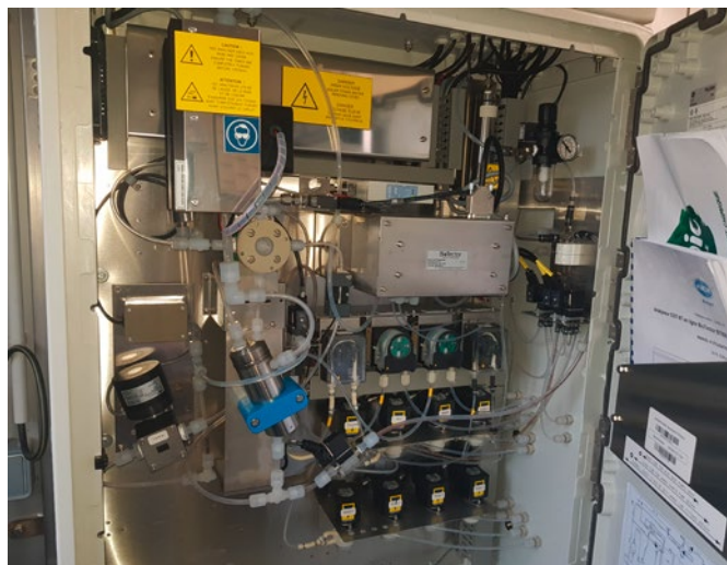
Analizzatore di TOC/TN BioTector B7000 a 6 flussi
