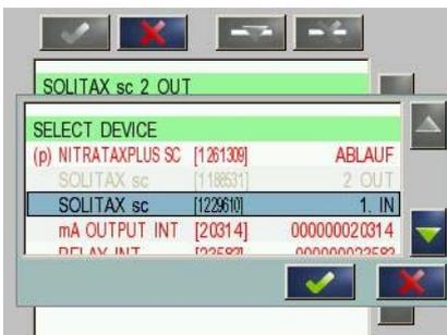
5. Wählen Sie den zweiten Sensor für das RTC-Modul aus und bestätigen mit der **ENTER**-Taste unter der Auswahlliste.
