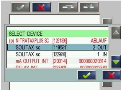
3. Tippen Sie den gewünschten Sensor für das RTC-Modul an und bestätigen mit der **ENTER**-Taste unter der Auswahlliste.
