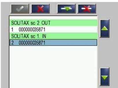
6. Um die Sensoren in die für das RTC-Modul vorgegebene Reihenfolge zu sortieren, tippen Sie den Sensor an und verschieben ihn mit den Pfeiltasten (Abbildung 6, Position 5). Mit der Taste **LÖSCHEN** (Abbildung 6, Position 4) können Sie einen falschen Sensor wieder aus der Sensorliste entfernen.
