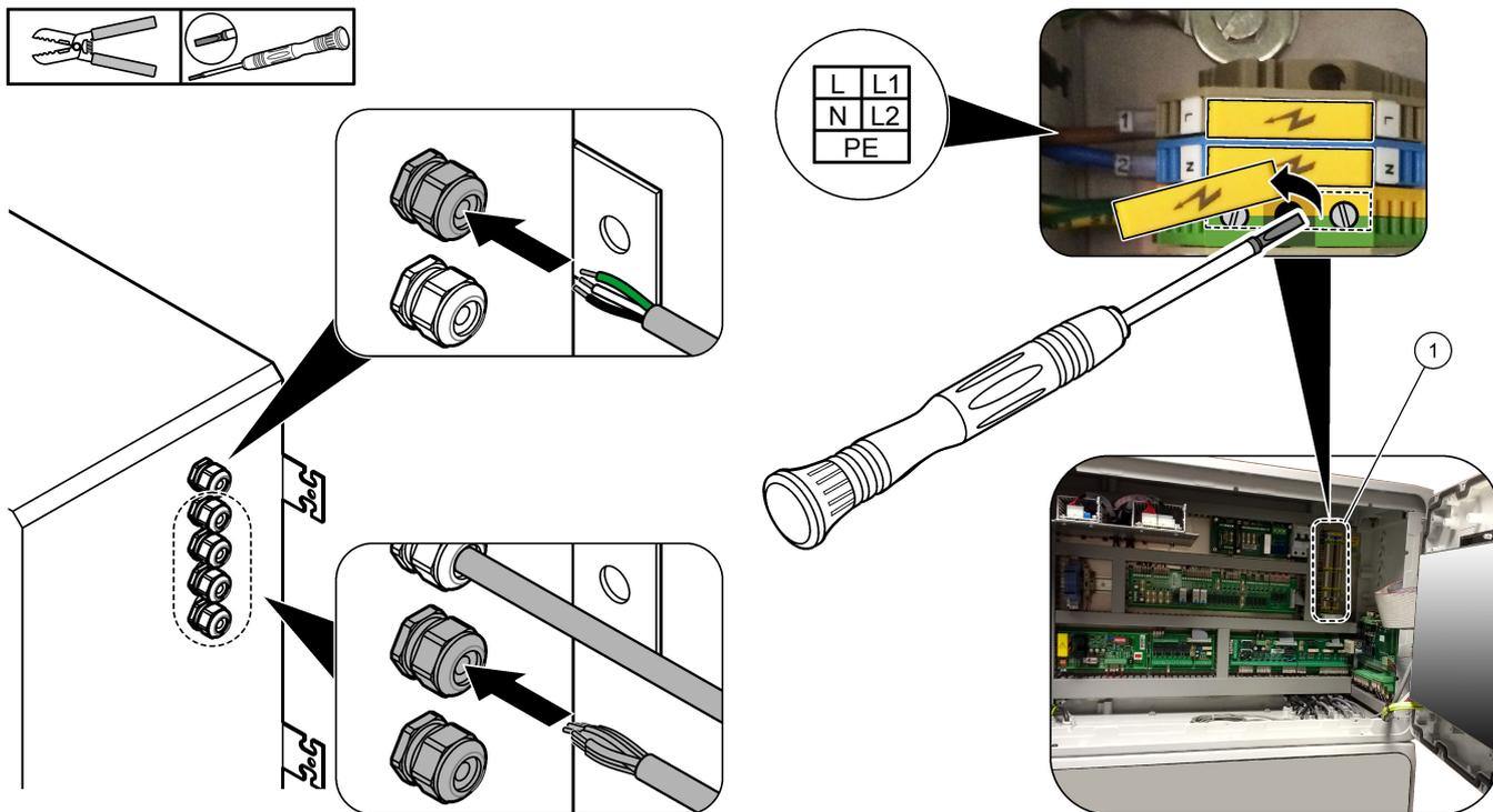
**1** Klemmen für Netzanschluss, analogen Ausgang und Relais
