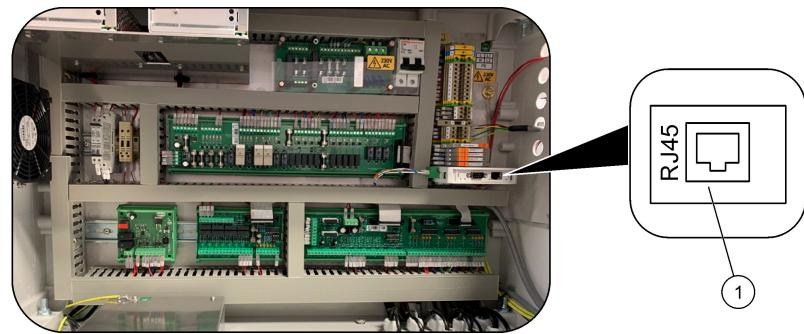
1 Modbus TCP/IP 连接器
