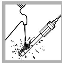
3. Spülen Sie die Sonde mit entionisiertem Wasser. Trocknen Sie die Sonde mit einem fusselfreien Tuch.
