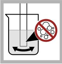
5. Schwenken Sie die Sonde, um Luftblasen zu entfernen.
