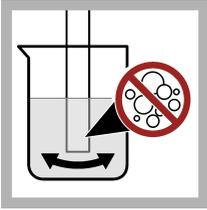
5. Schwenken Sie die Sonde, um Luftblasen zu entfernen.
