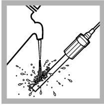
1. Spülen Sie die Sonde mit entionisiertem Wasser. Trocknen Sie die Sonde mit einem fusselfreien Tuch. Robuste Sonden: Installieren Sie die Sondenabschirmung.
