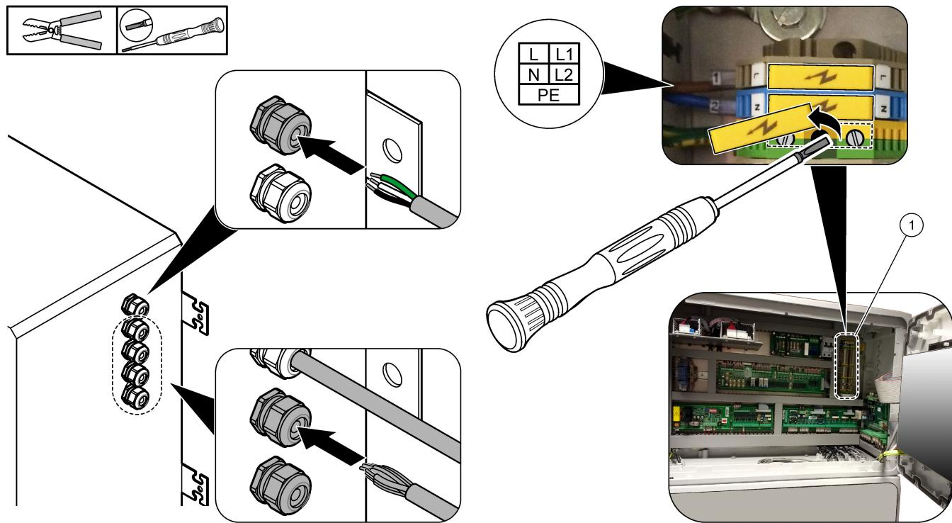
1 电源、模拟输出端和继电器端子
