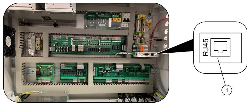
1 Modbus TCP/IP 连接器
