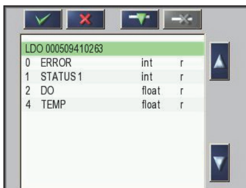
Slika 45 Izbornik za konfiguraciju Profibus/Modbus postavki – Device list (Popis uređaja)
