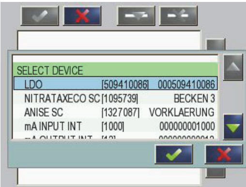
Slika 44 Izbornik za konfiguraciju Profibus/Modbus postavki –Select device (Odabir uređaja)
