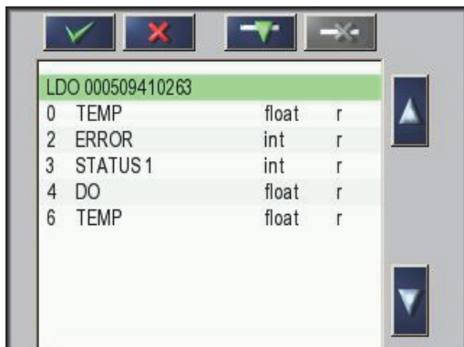
Slika 47 Izbornik za konfiguraciju Profibus/Modbus postavki – telegram popis s novom oznakom
