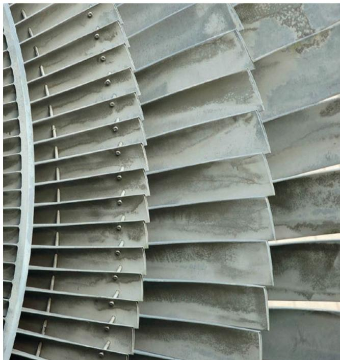
La deposizione di silice sulle palette delle turbine è un problema di importanza cruciale
