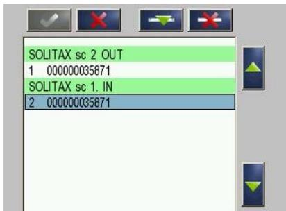
6. Per disporre i sensori nell'ordine specificato per il modulo RTC, premere il sensore e utilizzare i tasti freccia per spostarlo (Figura 6, voce 5). Premere **CANCELLA** (Figura 6, opzione 4) per rimuovere di nuovo un sensore errato dall'elenco dei sensori.
