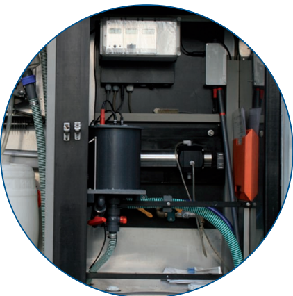
Obr. 1: Senzor NITRATAX plus sc na stanovení dusičnanů (obtokový), instalovaný na jednotce dávkovače vzorku
