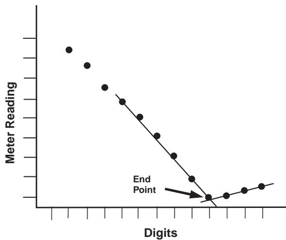
Figure 4 Back Amperometric Titration
