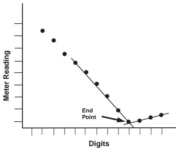
Figure 4 Back Amperometric Titration
