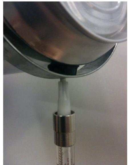
Abbildung 3: Luftinjektion in eine Dose
