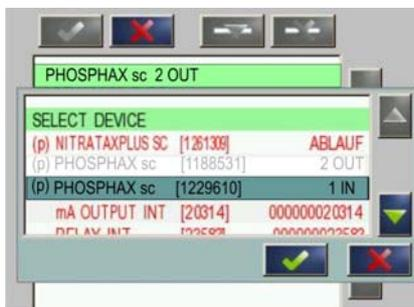
5. Sélectionnez le second capteur pour le module RTC et confirmez en appuyant sur **ENTRER** sous la liste de sélection.
