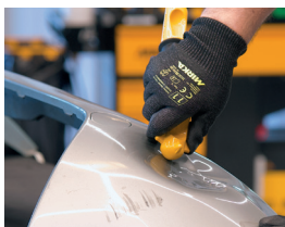
Abolladuras en para-choques
