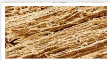
**⚡** Bois après ponçage avec oxyde d'aluminium.
