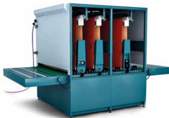
Un bon moyen de vérifier si les réglages sont bons est de contrôler l'utilisation des bandes les unes par rapport aux autres. Si les réglages sont effectués conformément aux exigences dictées par la séquence de grains et la machine, les bandes sont usées au même degré.
