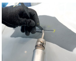
Pare-Chocs Fendus et Fissurés
