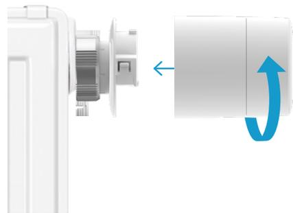
Coloca el Cabezal Termostático Inteligente
