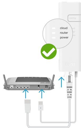
Conecta los cables de Ethernet y USB
