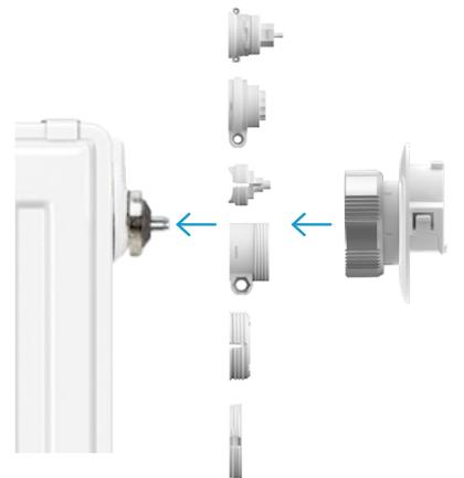
Fija el soporte de montaje (es posible que necesites un adaptador)
