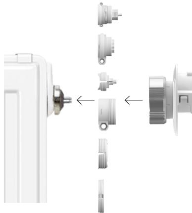
**Collega il supporto di montaggio (potrebbe essere necessario un adattatore)**
