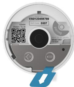
**Rimuovi l'etichetta dalle batterie per attivare il dispositivo**
