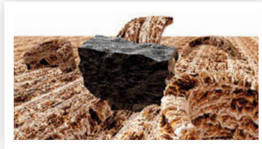
» Silikon karbür taneleri, sert ahşaplarda kolayca kesim yapar.
